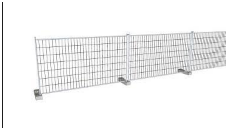
Figura 8 Recinzione tipo orso-grill con basamenti in calcestruzzo
