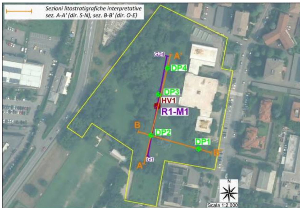
Fig. 10 - Posizionamento delle indagini geognostiche eseguite nel sito
